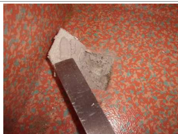
Prélèvement - P006 : BAT 23 - BARIETY / R+1 / PIECE / 2013 - Lé plastique- (Présence d'amiante)
