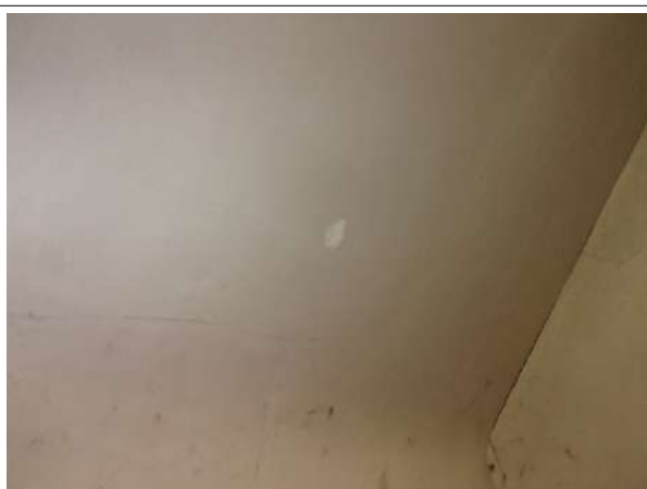
Prélèvement - P009 : BAT 23 BARIETY / R+4 / ASCENSEUR / MACHINERIE ASCENSEUR - Peinture- (Absence d'amiante)
