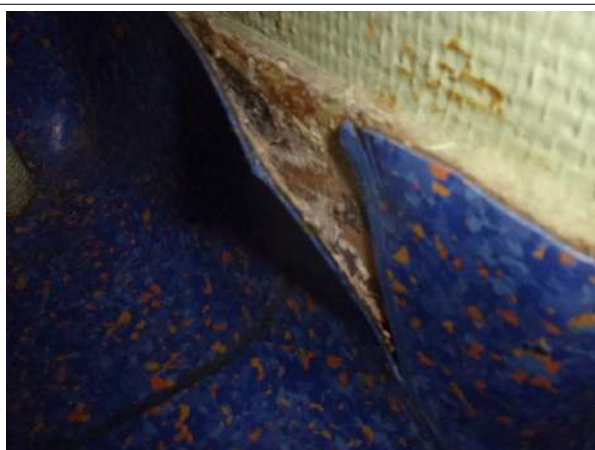
Prélèvement - P011 : BAT 23 - BARIETY / R+2 / PIECE / 3001 - Colle de plinthe- (Absence d'amiante)
