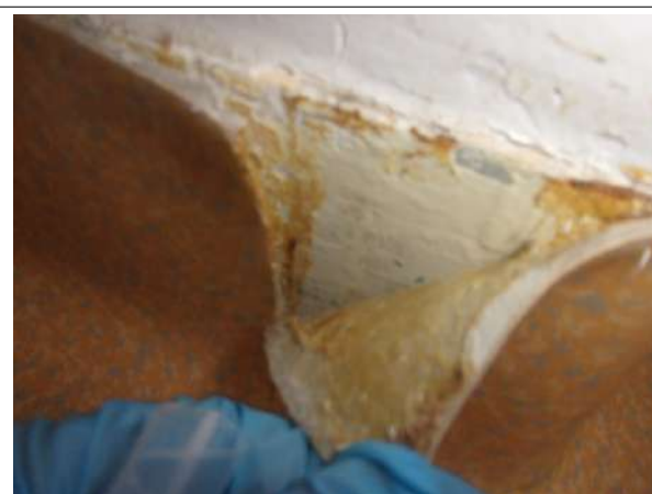
Prélèvement - P024 : BAT 23 - BARIETY / R+1 / PIECE / 2029 - Colle de plinthe- (Absence d'amiante)
