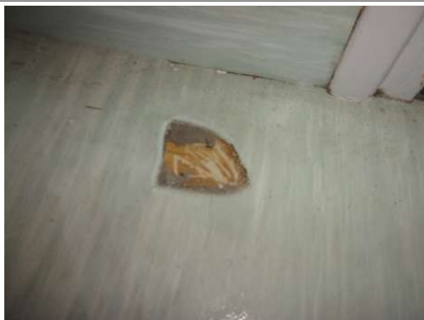
Prélèvement - P042 : BAT 23 - BARIETY / SOUS SOL / PIECE 0023 - Lé plastique- (Absence d'amiante)
