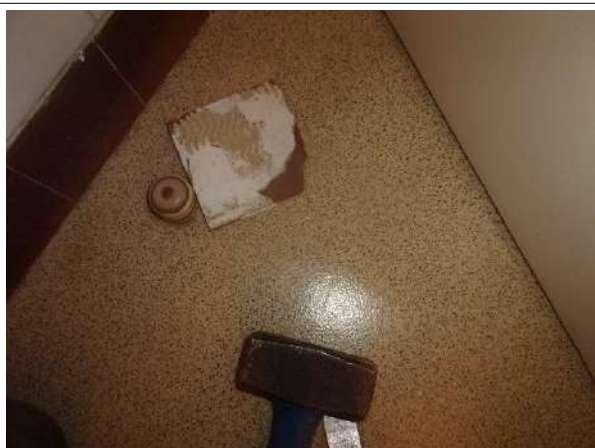
Prélèvement - P009 : BAT 23 - BARIETY / R+2 / PIECE / 3007 - Colle de plinthe- (Absence d'amiante)
