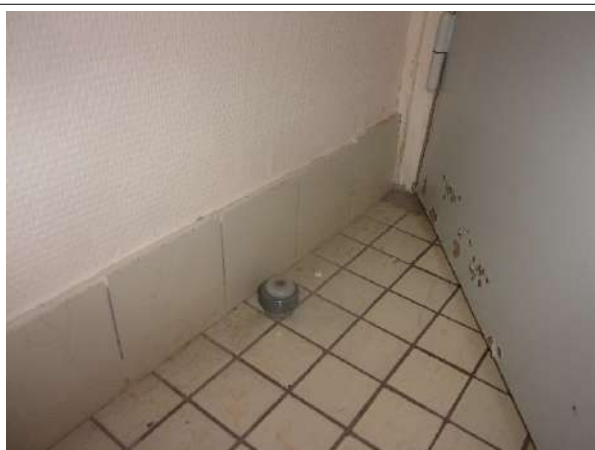
Prélèvement - P033 : BAT 23 - BARIETY / SOUS SOL / PIECE 0022 - Colle de carrelage- (Absence d'amiante)
