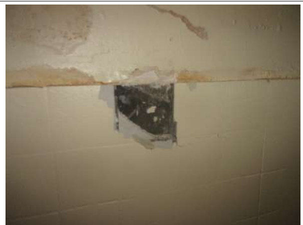
Prélèvement - P041 : BAT 23 - BARIETY / SOUS SOL / PIECE 0023 - Colle de faïence- (Absence d'amiante)
