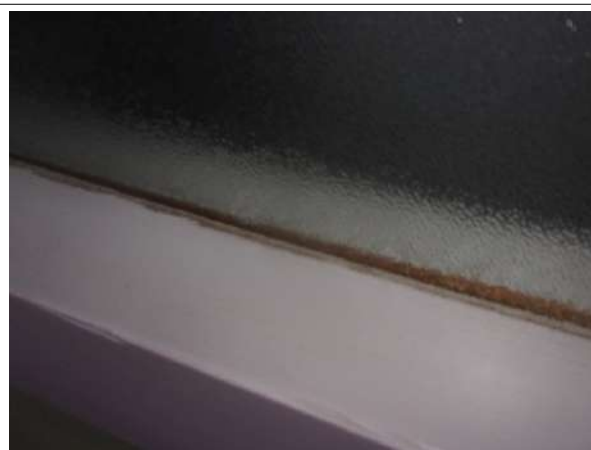
Prélèvement - P012 : BAT 23 - BARIETY / R+2 / PIECE / 3001 - Joint- (Absence d'amiante)
