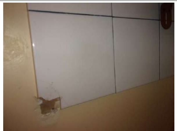
Prélèvement - P013 : BAT 23 - BARIETY / RDC / PIECE 1003 - Colle de faïence- (Absence d'amiante)
