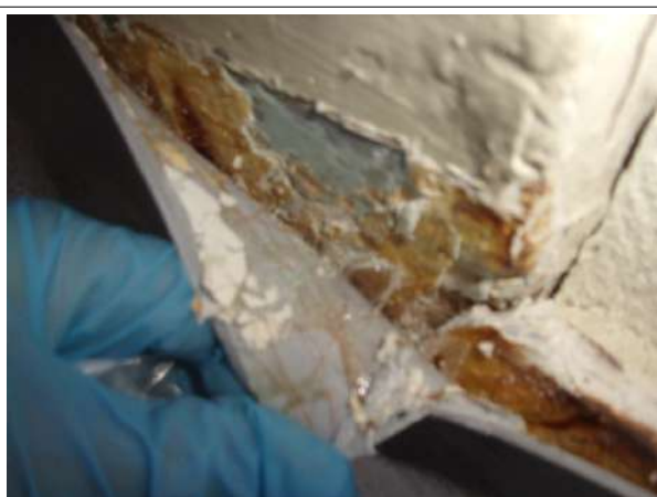
Prélèvement - P023 : BAT 23 - BARIETY / R+1 / PIECE / 2025 - Colle de plinthe- (Absence d'amiante)
