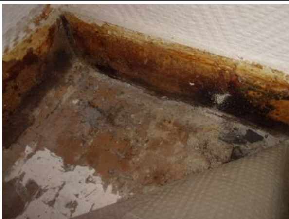
Prélèvement - P009 : BAT 23 - BARIETY / R+1 / PIECE / 2006 - Colle- (Absence d'amiante)
