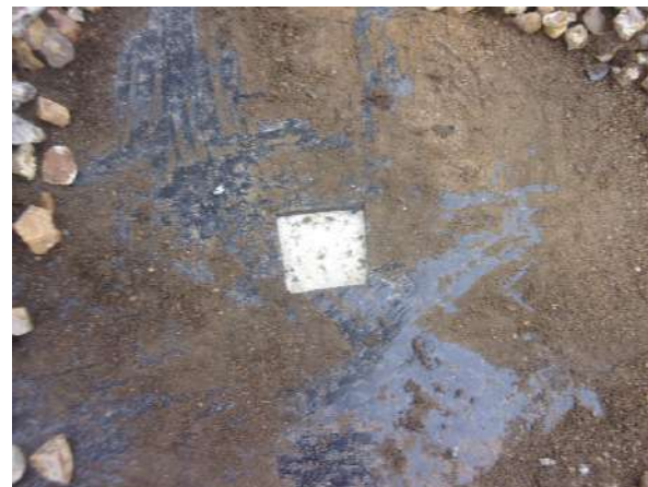
Prélèvement - P002 : BAT 23 - BARIETY / EXTERIEUR / TOITURE TERRASSE CHAUFFERIE - Revêtement bitumineux - (Absence d'amiante)
