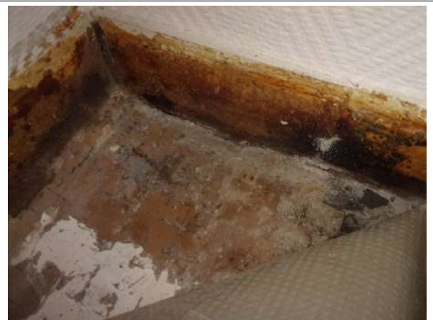
Prélèvement - P010 : BAT 23 - BARIETY / R+1 / PIECE / 2006 - Colle de carrelage- (Absence d'amiante)
