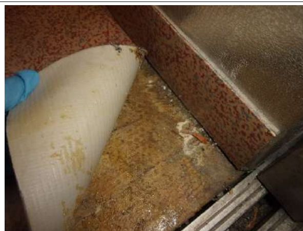
Prélèvement - P20 : BAT 23 BARIETY / R+4 / ASCENSEUR / CABINE - Colle- (Présence d'amiante)
