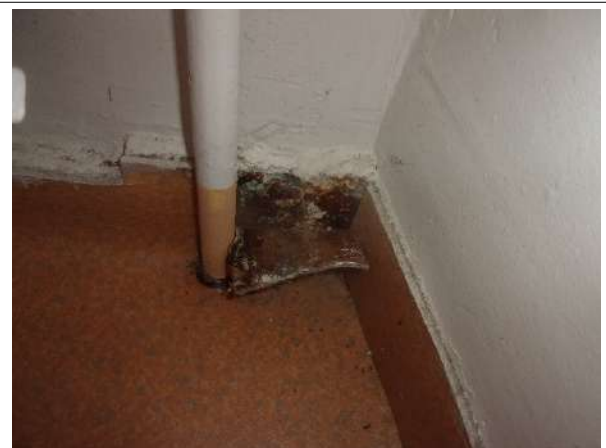
Prélèvement - P018 : BAT 23 - BARIETY / R+1 / PIECE / 2029 - Colle de carrelage- (Absence d'amiante)
