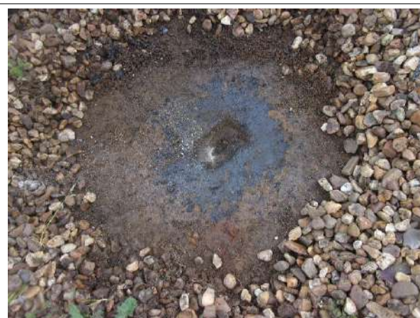
Prélèvement - P004 : BAT 23 - BARIETY / EXTERIEUR / TOITURE TERRASSE ETAGE 2 - Revêtement bitumineux- (Absence d'amiante)
