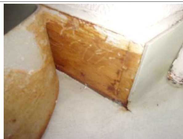
Prélèvement - P022 : BAT 23 - BARIETY / R+1 / PIECE / 2024 - Colle de plinthe- (Absence d'amiante)
