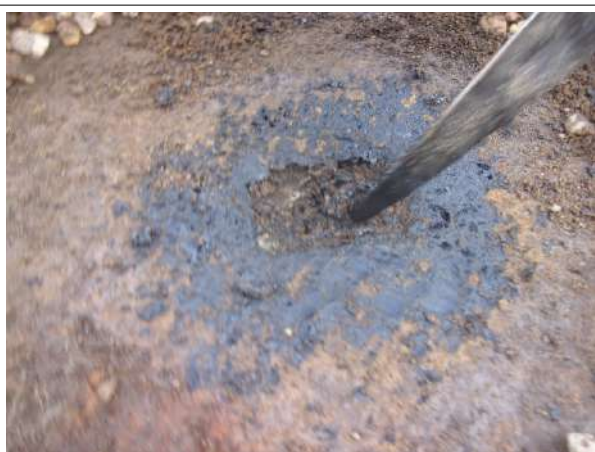
Prélèvement - P007 : BAT 23 - BARIETY / EXTERIEUR / TOITURE TERRASSE ETAGE 2 - Revêtement bitumineux- (Absence d'amiante)
