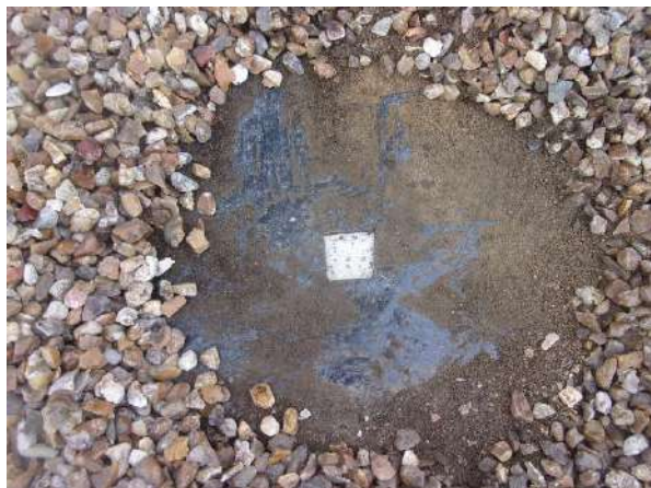
Prélèvement - P001 : BAT 23 - BARIETY / EXTERIEUR / TOITURE TERRASSE CHAUFFERIE - Revêtement bitumineux - (Absence d'amiante)
