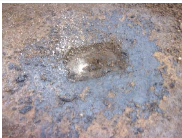
Prélèvement - P005 : BAT 23 - BARIETY / EXTERIEUR / TOITURE TERRASSE ETAGE 2 - Revêtement d'étanchéité- (Absence d'amiante)
