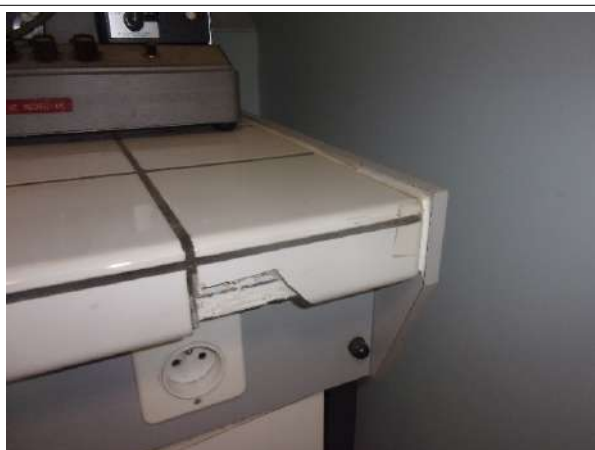
Prélèvement - P044 : BAT 23 - BARIETY / SOUS SOL / PIECE 0029 - Colle de faïence- (Absence d'amiante)
