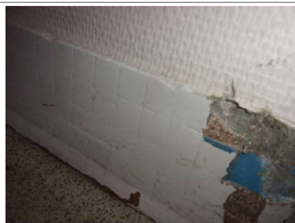
Prélèvement - P006 : BAT 23 - BARIETY / R+2 / PIECE / 3031 - Colle de plinthe- (Absence d'amiante)
