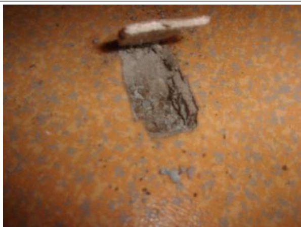
Prélèvement - P017 : BAT 23 - BARIETY / R+1 / PIECE / 2029 - Colle de carrelage- (Absence d'amiante)
