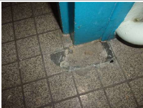
Prélèvement - P001 : BAT 23 - BARIETY / SOUS SOL / PIECE 0013 - Colle de carrelage- (Absence d'amiante)
