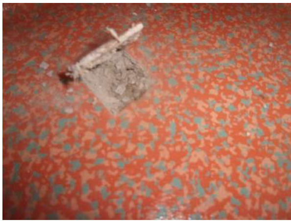
Prélèvement - P007 : BAT 23 - BARIETY / R+1 / PIECE / 2015 - Lé plastique- (Absence d'amiante)
