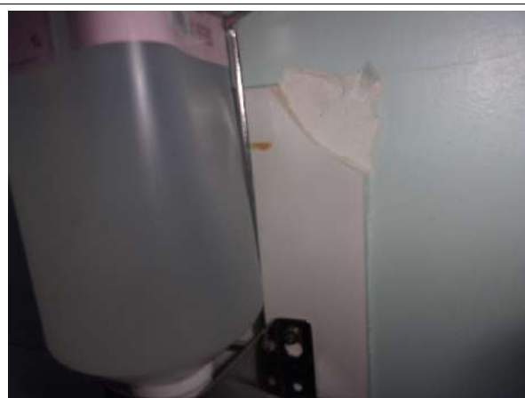
Prélèvement - P006 : BAT 23 - BARIETY / RDC / PIECE 1039 - Colle de faïence- (Absence d'amiante)
