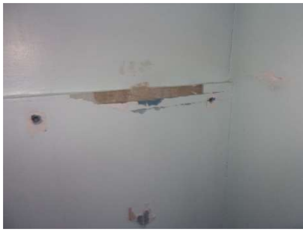
Prélèvement - P007 : BAT 23 - BARIETY / RDC / PIECE 1038 - Colle de faïence- (Absence d'amiante)
