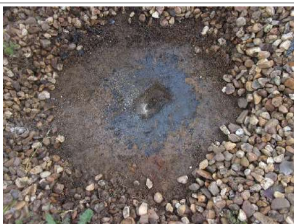
Prélèvement - P009 : BAT 23 - BARIETY / EXTERIEUR / TOITURE TERRASSE ETAGE 2 - Ragréage- (Absence d'amiante)
