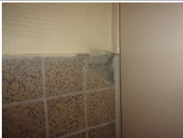
Prélèvement - P001 : BAT 23 - BARIETY / R+1 / PIECE / 2034 - Colle de faïence- (Absence d'amiante)
