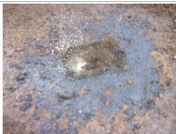
Prélèvement - P008 : BAT 23 - BARIETY / EXTERIEUR / TOITURE TERRASSE ETAGE 2 - Revêtement d'étanchéité- (Absence d'amiante)
